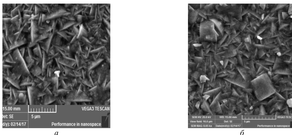
Рис. Микрофотографии СЭМ композиционных покрытий на основе цинковой матрицы, увеличение 8500×
