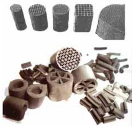
Рис. 1. Мезопористый углеродный материал Сибунит различных форм и размеров
