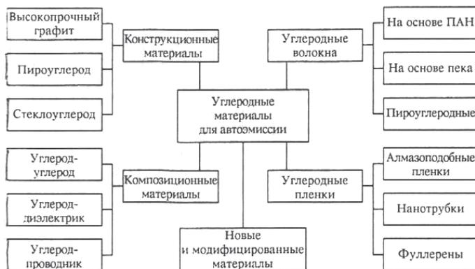
Рис. 1. Классификация типов углеродных материалов, представляющих интерес для изготовления автокатодов
