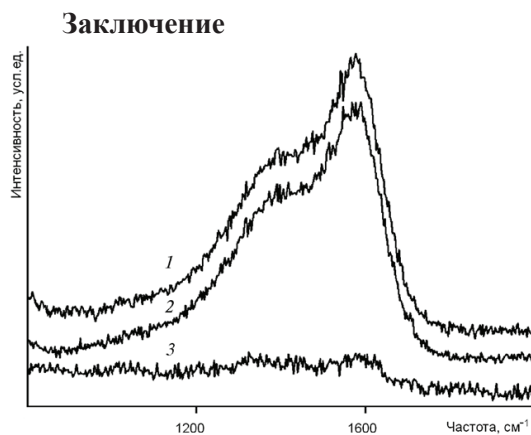
Рис. 2. Спектры КРС углерода на поверхности образца на частицах углеродной фазы в зоне (1) и вне зоны (2) электроконтакта и в медной матрице в зоне электроконтакта (3)
