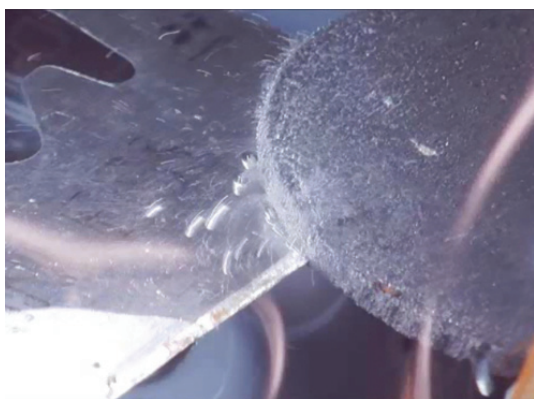
Рис. 4. Фрагмент видеозаписи, демонстрирующей выделение газов при подаче напряжения на таблетку композита, погруженную в дистиллированную воду. Выделение газа происходит по всей поверхности образца, находящейся вблизи электрода (газ выделяется из-под второго электрода)
