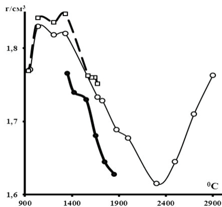
Рис. 2. Зависимость изменения объёмной плотности УВ от температуры карбонизации, на ЛПУ-1: УВ из ПАН-волокна ООО «СНВ» —○— окисленного на ЧЭЗе и --□-- окисленного на ООО «Аргон»; —●— УВ из ПАН-волокна «Exlan»
