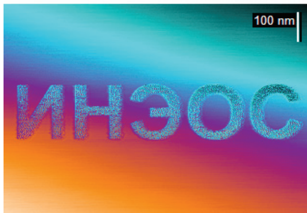
Рис. 2. Надпись на поверхности высокоориентированного пиролитического графита производства ООО «Атомграф-Кристалл», выполненная с помощью локального анодного окисления с использованием сканирующего зондового микроскопа ФемтоСкан. Изображение получено в режиме картирования латеральных сил
