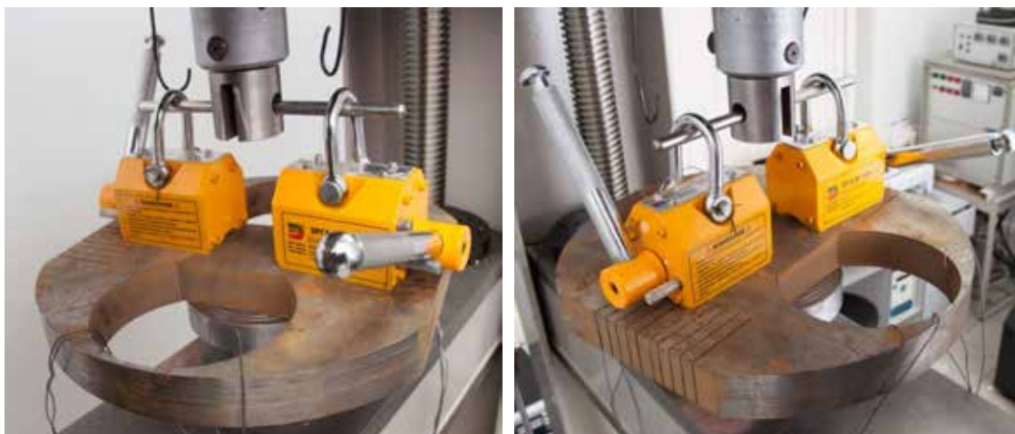
Рисунок 168 – Экспериментальные исследования силы удержания обеспечиваемой парой магнитов используемых в модуле крепления и позиционирования измерительного индентационного модуля iPoRTH
