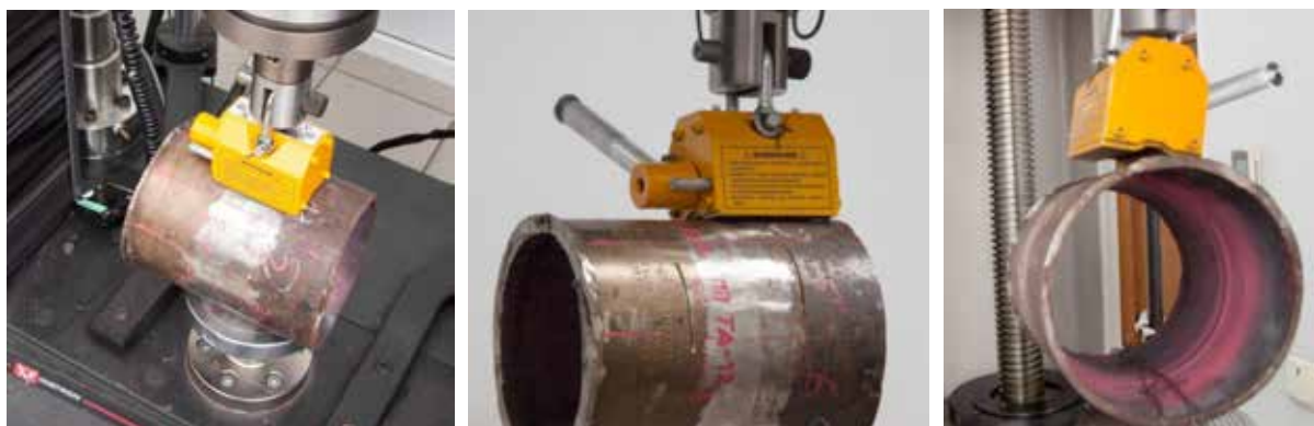
Рисунок 169 – Исследования силы удержания, обеспечиваемой одним магнитом при его креплении к стальной трубе диаметром 160мм с толщиной стенок 10мм
