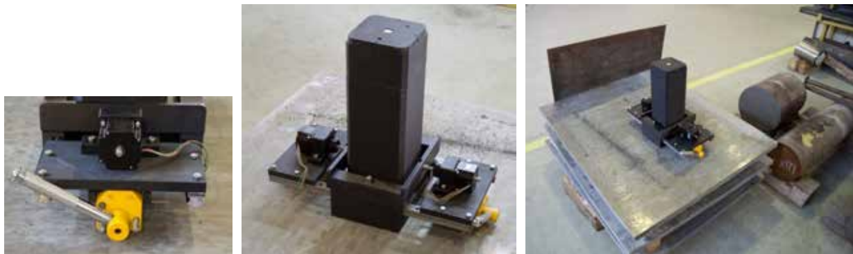
Рисунок 170 – Изображение экспериментального образца измерительного модуля iPoRTN установленного на плоский металлический лист, магнитные держатели находятся в рабочем положении.
