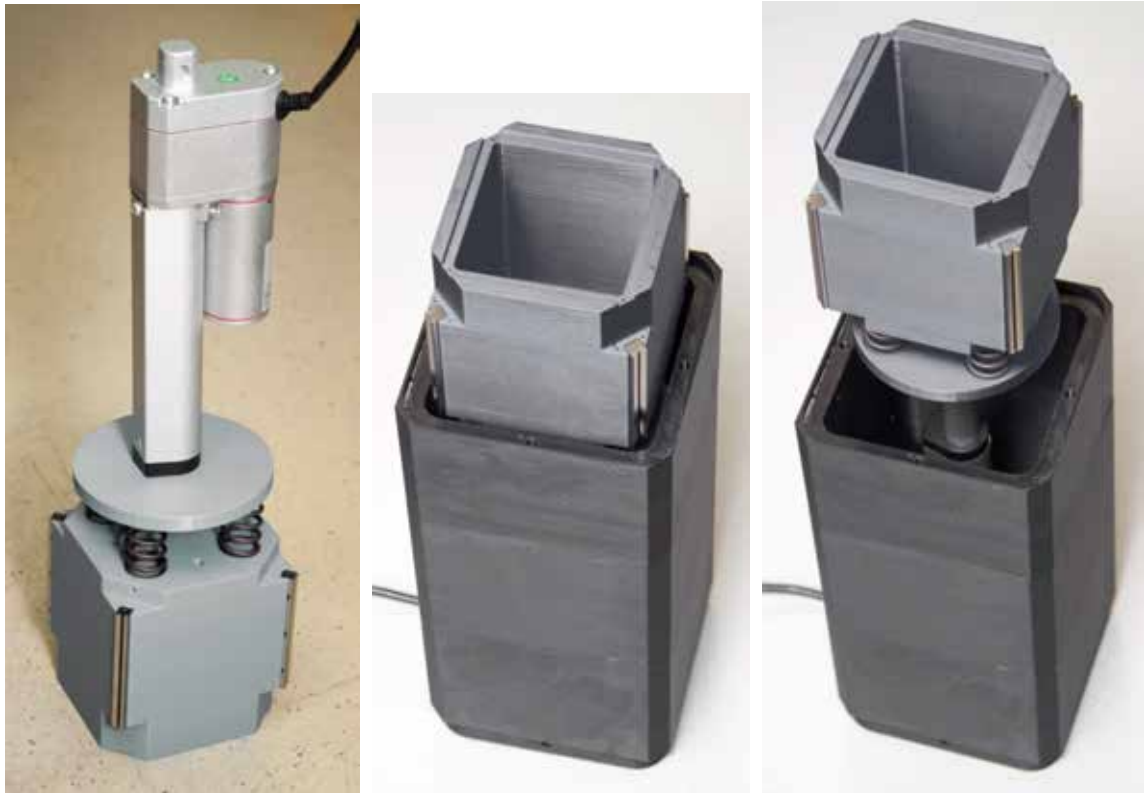
Рисунок 76 – Актюатор и обеспечиваемое им перемещение подвижного узла iPoRTH
