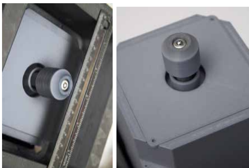
Рисунок 79 – Крупный план индентирующей головки экспериментального образца измерительного модуля iPoRTH
