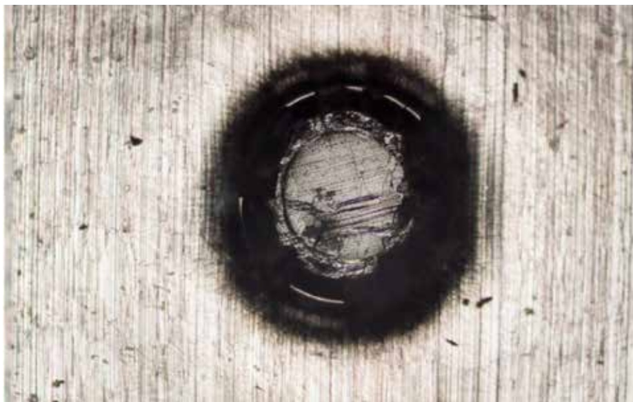
Рисунок 110 — шарик, сколотый по краям плоской лыски
