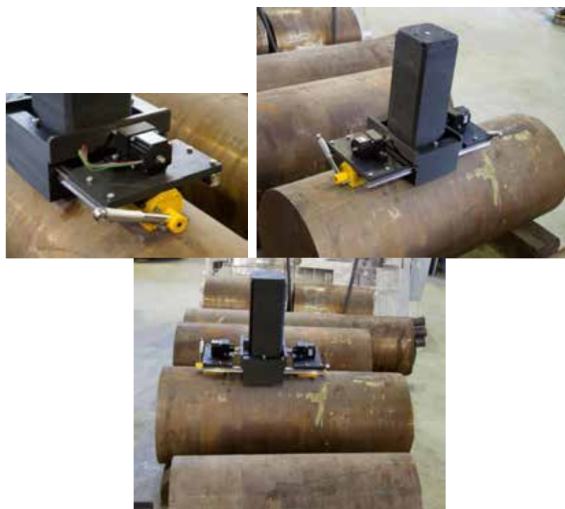
Рисунок 171 – Изображение экспериментального образца измерительного модуля iPoRTN установленного на цилиндрическую металлическую заготовку, магнитные держатели находятся в рабочем положении
