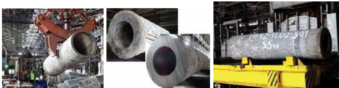
Рисунок 174 – Примеры трубных заготовок изготовленных на РМЦ1000
