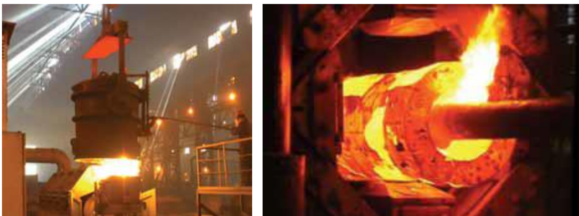
Рисунок 173 – Этапы производства полого литого изделия
