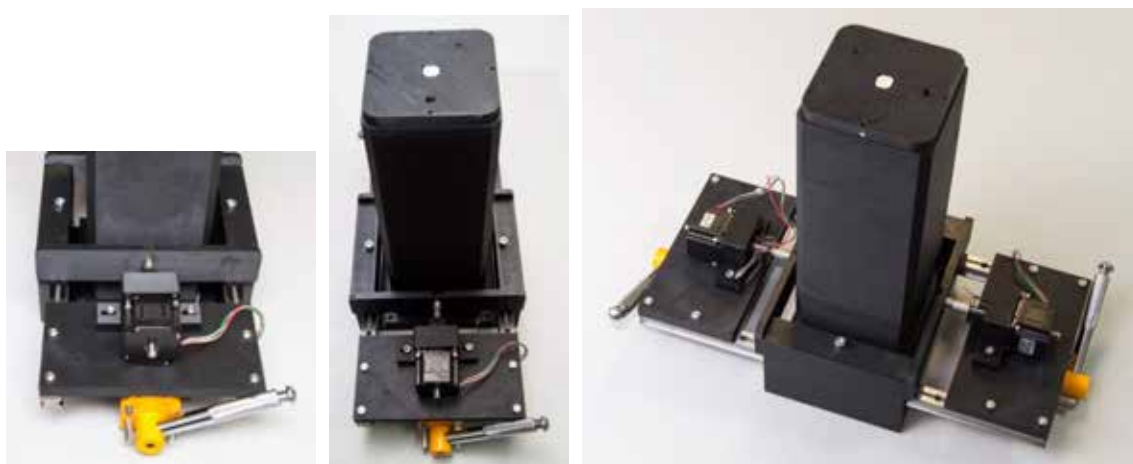
Рисунок 165 – Этапы установки удерживающих магнитов в систему крепления и позиционирования экспериментального образца измерительного модуля iPoRTH
