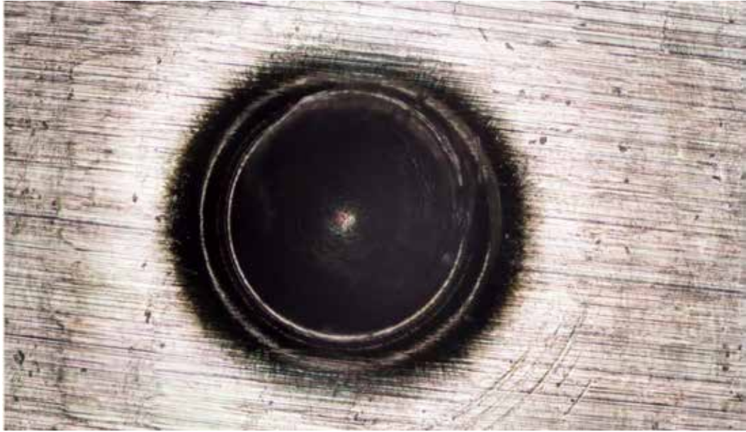
Рисунок 116 — шарик, запрессованный в опоре со слоем клея на основе цианакрилата
