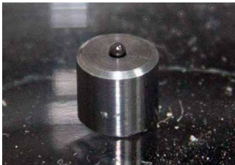
Рисунок 112 — шарик в лунке твердосплавной опоры
