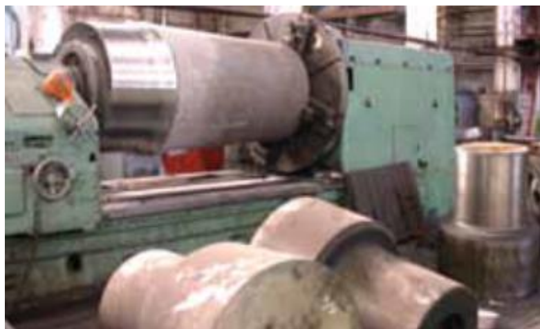
Рисунок 175 – Обработка заготовки на токарном станке
