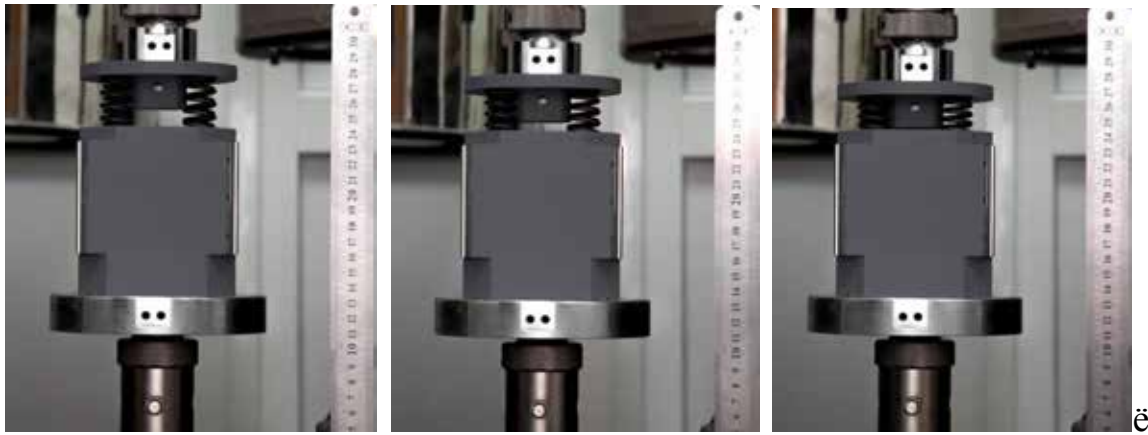
Рисунок 81 – Схема измерительного нагружения пружинного блока
