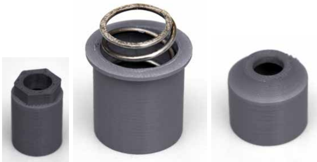
Рисунок 75 – Элементы, обеспечивающие крепление индентора и упор опорного кольца в поверхность образца с заданной силой
