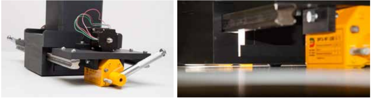
Рисунок 166 – Изображение экспериментального образца измерительного модуля iPoRTN и измерительного сфероконического индентора, закрытого упорным элементом в контакте с поверхностью объекта, на котором установлена система крепления и позиционирования
