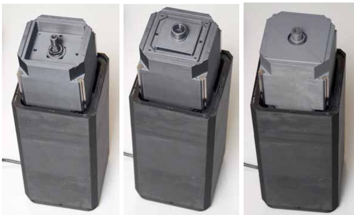
Рисунок 77 – Силочувствительный элемент и датчик перемещения, установленные в корпус iPoRTN без последней крепежной секции., последовательные стадии процесса
