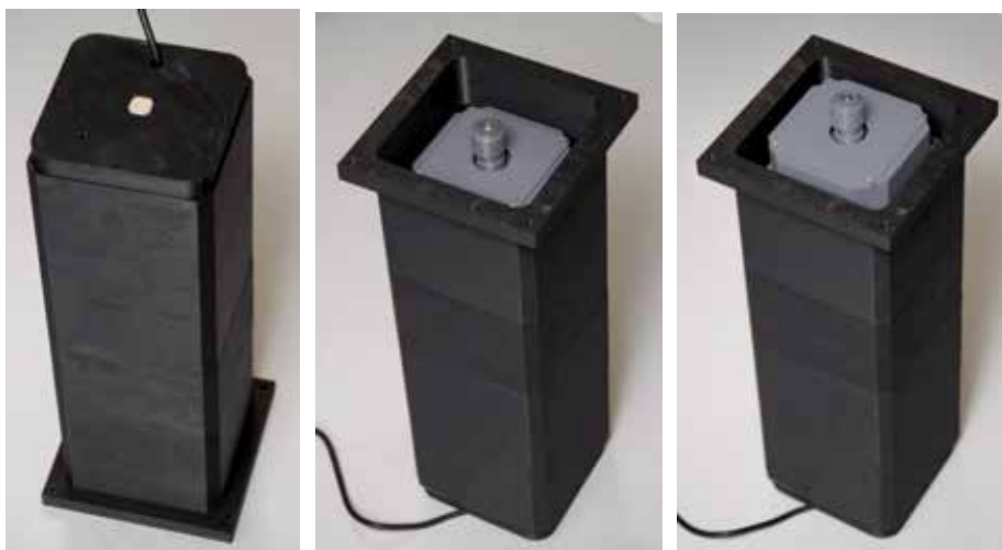
Рисунок 78 – Вся конструкция экспериментального образца индентационного измерительного модуля iPoRTH в сборе в рабочем и перевернутом положении
