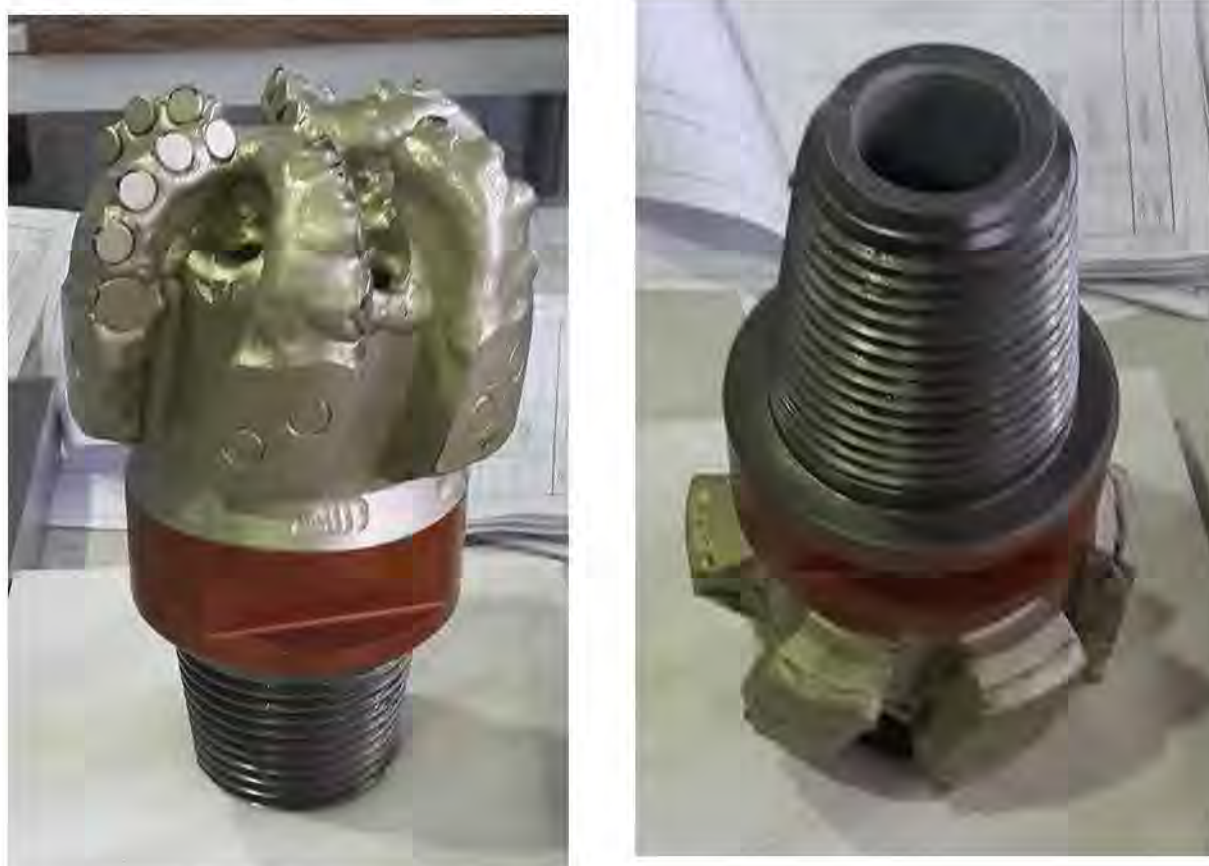
Рисунок 22 – Пример долота, использующегося в отечественной промышленности и имеющего посадочное место сантиметрового масштаба линейных размеров
