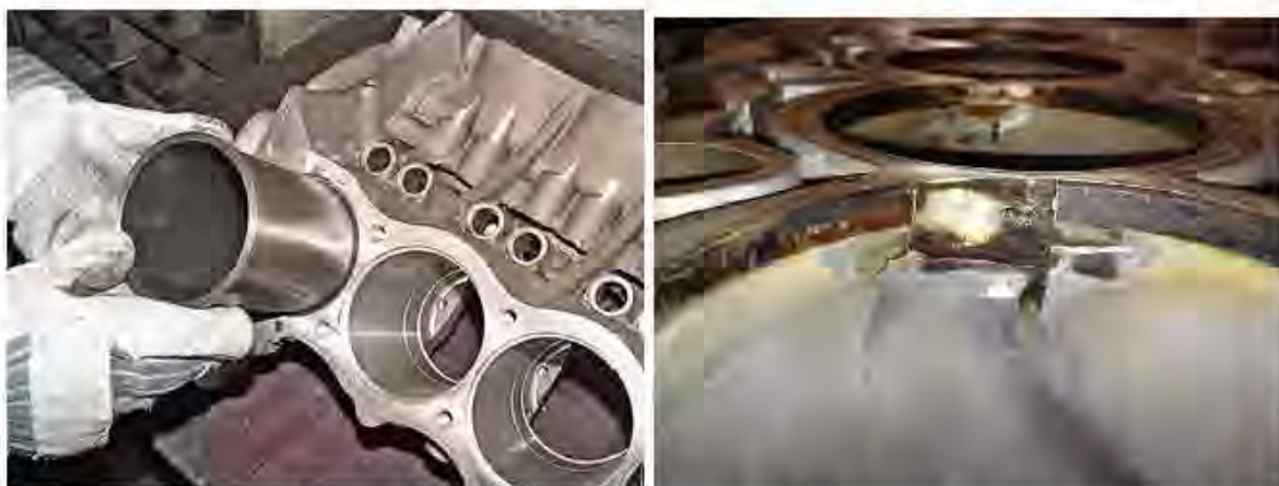
Рисунок 25 – а) Изображение блока цилиндров со вкладышами [28], б) повреждение вкладышей цилиндра [29]
