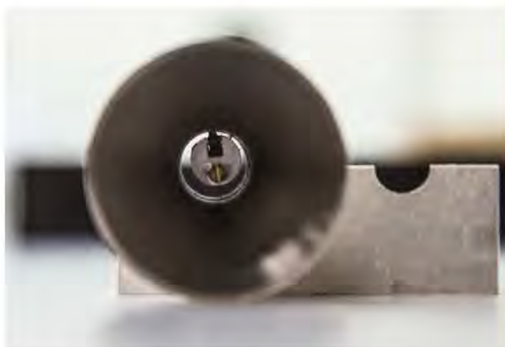
Рисунок 30 – Измерение шероховатости внутренней поверхности воронки-податчика при помощи ЭОСНП
