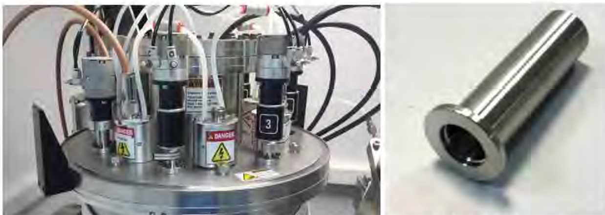
Рисунок 18 – Вакуумные вводы установки AJA ORION
