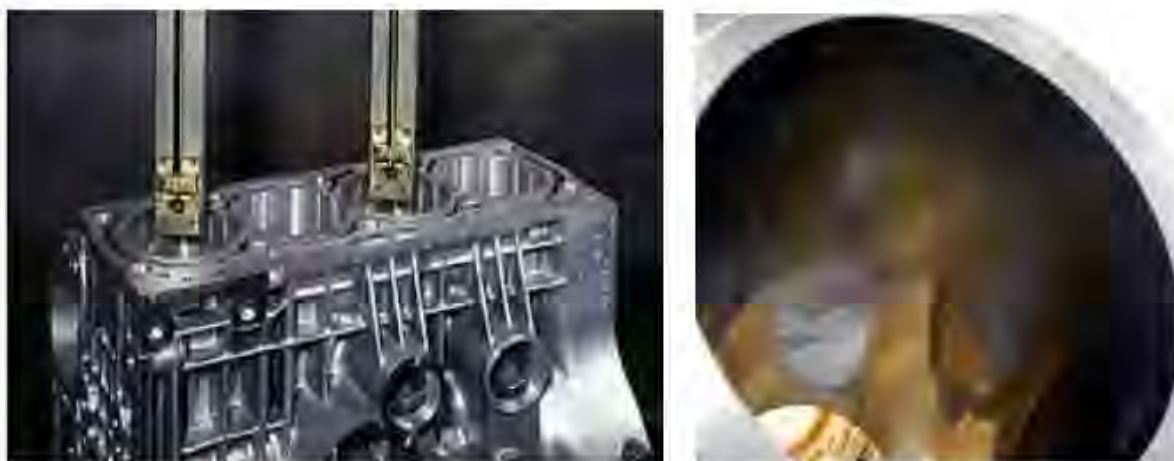
Рисунок 26 – Покрытия SUMEboге и цилиндры двигателя [32]: а) алюминиевый блок цилиндров двигателя с плазменными факелами, использующимися для напыления б) Вкладыш цилиндра с покрытием (диаметр 20 см)
