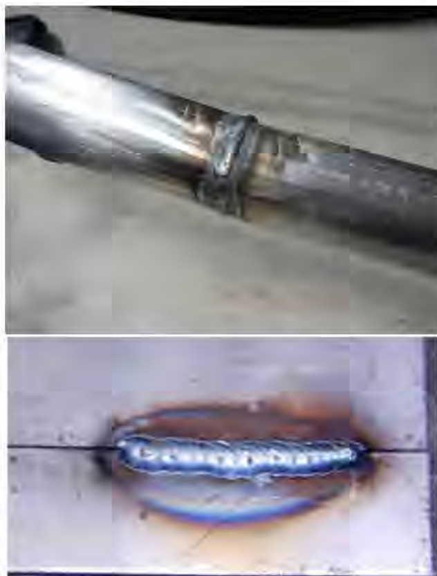
Рисунок 31 – Сварные швы, связывающие поверхности труб [36] и листов [37]
