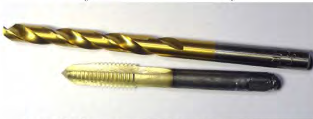
Рисунок 38 – Изделия с покрытием из нитрида титана, наносимым различными компаниями: а- Eifeler (Австрия) [42], б – North Star Coating (США) [43], в – Дугатрон (Россия) [44]
