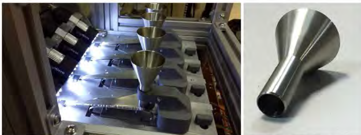
Рисунок 29 – Фрагмент установки для сортировки кристаллов, использующей конический элемент загрузочного устройства (воронка-податчик)
